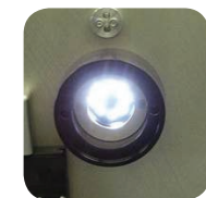
▲ Светодиодный (СИД) осветитель СИД осветитель в форме кольца для анализа плавления золы от 500 °C до 1500 °C.
