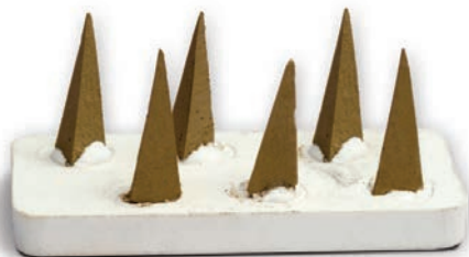
◀ Образцы ASTM Образец-конус золы по ASTM.
