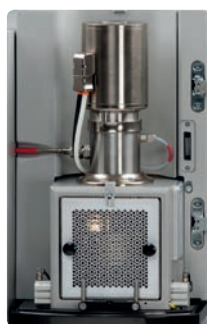
▲ Автоочистка Система автоочистки LECO чистит трубку сжигания и пылевой фильтр.
