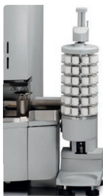
▲ Автозагрузчик Автозагрузчик вместимостью на 10 или на 60 образцов.
