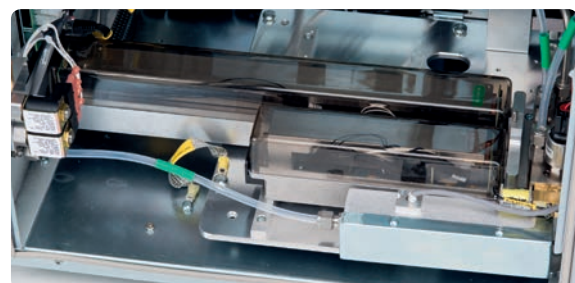
▲ Автозагрузчик Автозагрузчик вместимостью на 10 или на 60 образцов.
