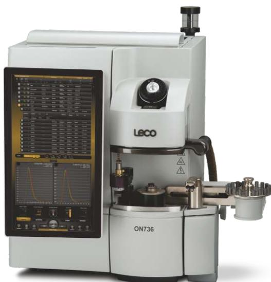
Комплектация с опциональной системой автоочистки и автозагрузчиком
