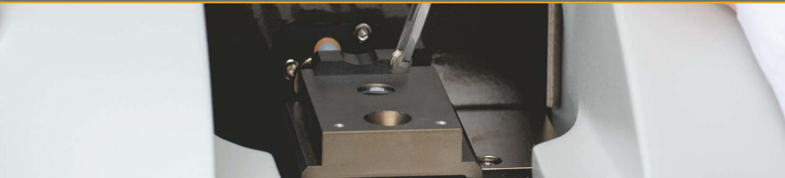
LECO ON736: анализ кислорода/азота методом плавления
