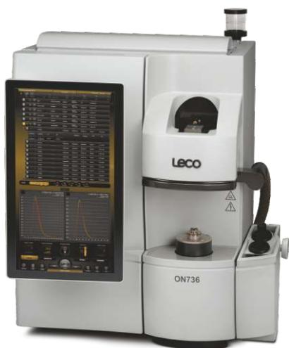
Комплектация с сенсорным монитором, закрепленным на корпусе прибора
