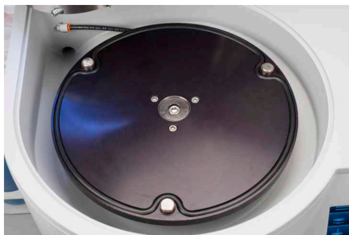
Спиралевидная чаша с функцией автоматической очистки
