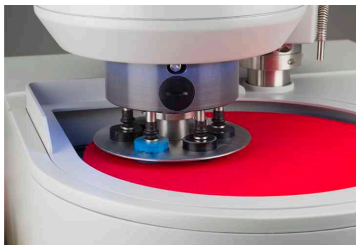
Улучшенная конструкция индивидуальных держателей образцов
