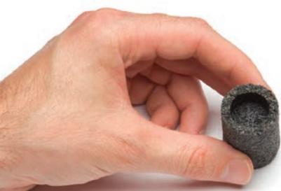
◀ Пористый тигель Пористый тигель обеспечивает максимально полное сгорание пробы, препятствуя обратному выдуванию газов.
